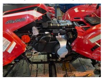
步骤二:装上绞盘自带控制器(装在车架右前侧)
