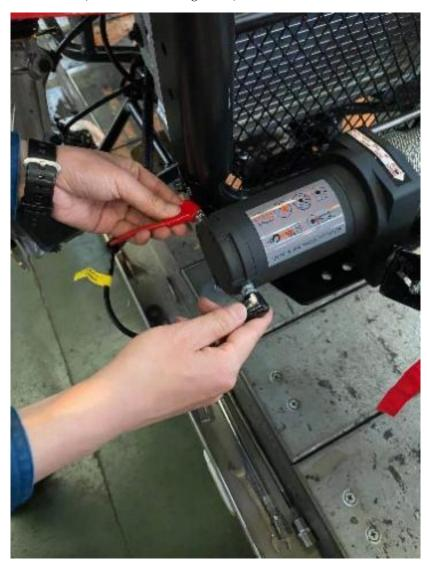
步骤五:将控制器延伸出来的主电缆,沿着车架左侧排线,直至电瓶处。
